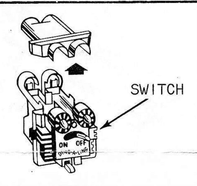
BE SURE SWITCH ON POWER PACK IS IN "OFF" POSITION. LIFT OFF BATTERY COVER AS SHOWN. 2
